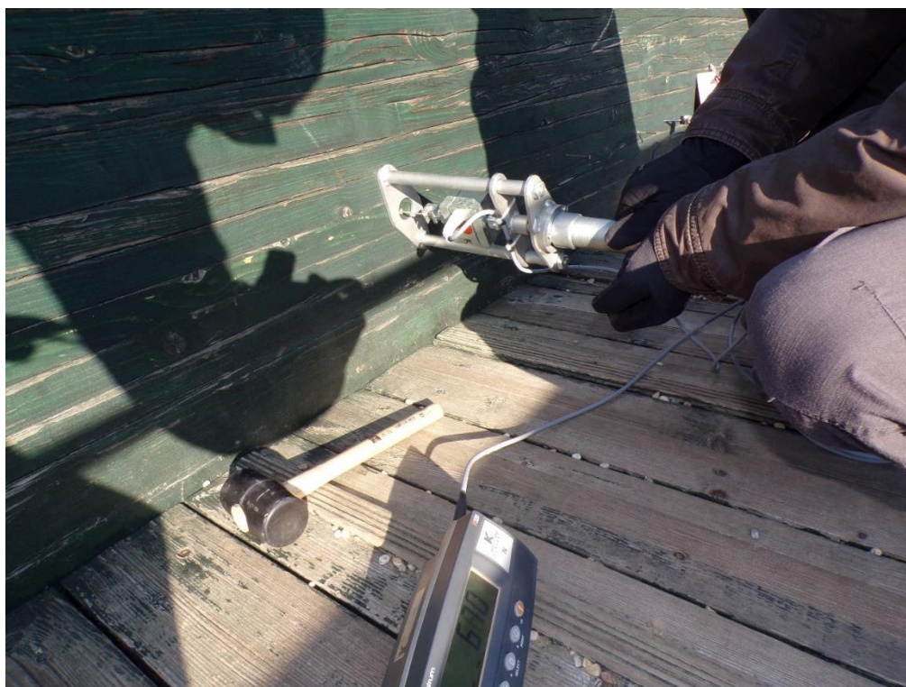
3. ábra: Csavarállóság mérése a „B” tartón
